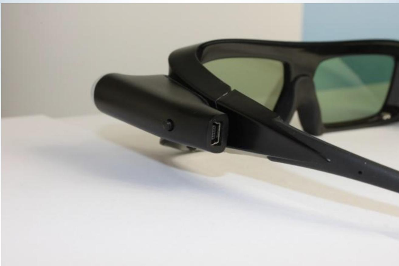
Аккумулятор, светодиод и схема зарядки аккумулятора расположены сбоку очков в двух маркерах. Также на каждом маркере расположен порт mini-USB и кнопка включения/выключения очков. Размеры и форма маркеров показаны на чертеже. Необходимо сделать компактное бесконтактное устройство зарядки, позволяющее вырабатывать напряжение 5 В внутри маркеров при силе тока 0,5 А. Часть этого устройства, расположенная в очках, должна уместиться в маркере.
